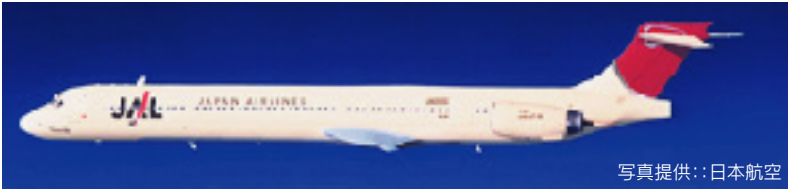
MD90 全長46.5m:全幅32.9m:標準座席数166席:巡航速度815km/h
