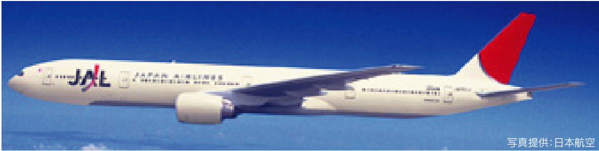
B777-300 全長73.9m:全幅60.9m:標準座席数470席:巡航速度905km/h
