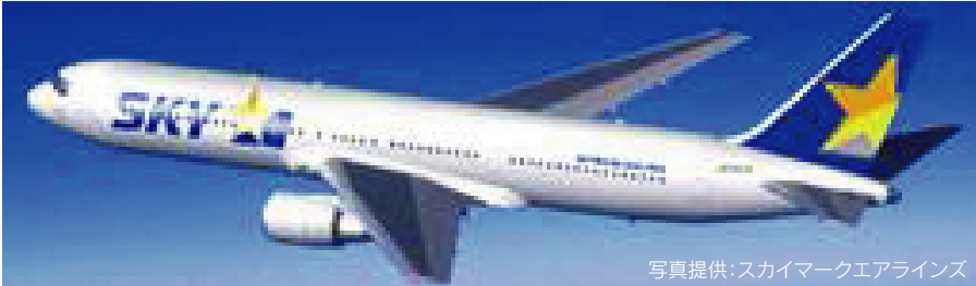
B767-300ER 全長54.9m:全幅47.6m:標準座席数309席:巡航速度880km/h
