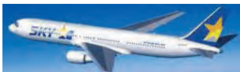
B767-300ER 全長54.9m:全幅47.6m:標準座席数309席:巡航速度880km/h
