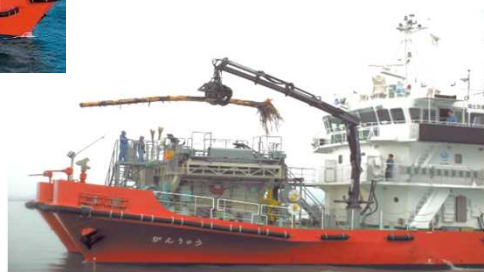
多関節クレーンによる流木回収状況
