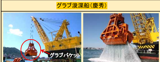
※「慶秀」は、ワイヤーロープによって吊り下げられたグラブバケットを使用した浚渫動作(デモンストレーション)を実施。
