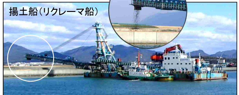
▲取り除いた土砂は長州出島の埋立材として有効利用します。
