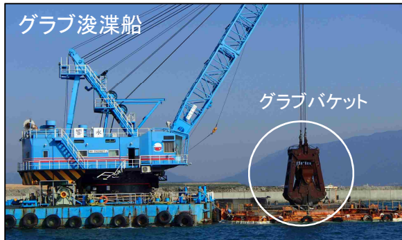
▲10トンダンプトラック約4台分の土砂を一度につかむことができます。
