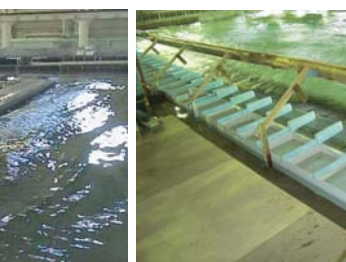
⑪越波流量は、護岸背後に設置した柵に護岸を超えてきた水を集めて計測する。
