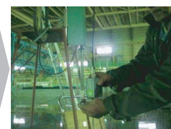
⑧波高を計測する計器（容量式波高計）設置
