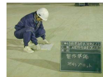
①模型製作図面を作成し、実験場床面に描いた座標軸に、海底地形（海岸線、等深線等）をプロットする。
