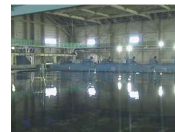
⑨現地で発生する波浪を波高計を使って再現する。
