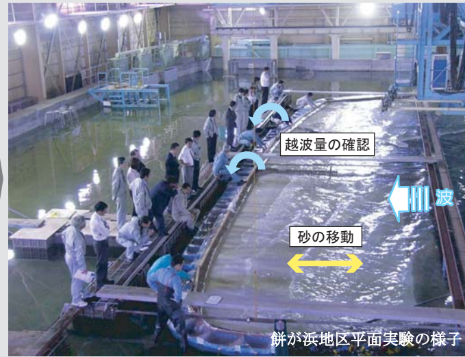
設置した平面模型に現地で発生する波を長時間あてて、砂浜がどう移動していくかを実験しました。また台風時などの大きな波を起こして、どれくらいの波が護岸を越えていくのかを実験し、安全を確かめました。
