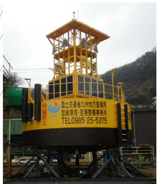
写真-1:GPS 波浪計の全景
