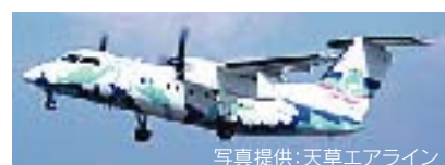
DASH8-100 全長22.3m:全幅25.9m:標準座席数39席:巡航速度502km/h
