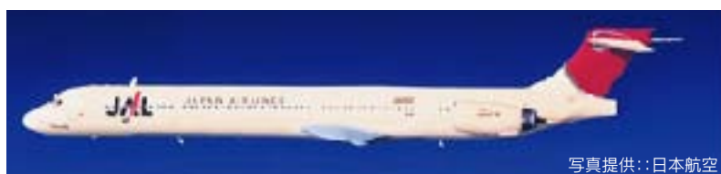
MD90 全長46.5m:全幅32.9m:標準座席数166席:巡航速度815km/h
