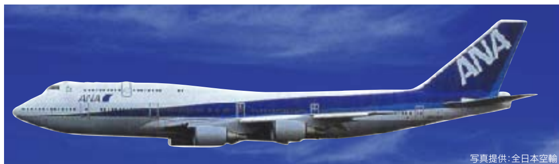
B747-400 全長70.7m:全幅59.6m:標準座席数569席:巡航速度910km/h
