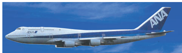
B747-400D 全長70.7m:全幅59.6m:標準座席数569席:巡航速度910km/h
