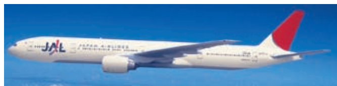
B777-300 全長73.9m:全幅60.9m:標準座席数470席:巡航速度905km/h
