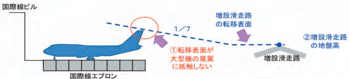
【例②:大型機の尾翼と増設滑走路転移表面の関係】
