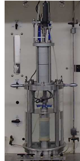
繰り返し非排水三軸試験状況
