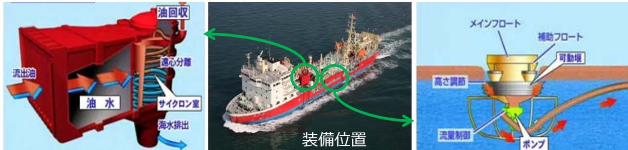
舷側設置式油回収器
