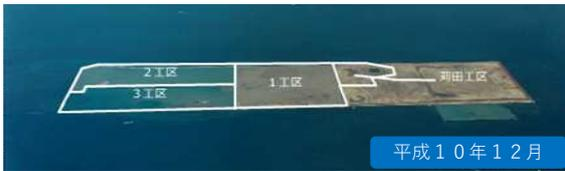
第2工区の護岸工事概成、埋立開始
