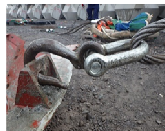
使用していた吊りフック (外れ止め無し)
