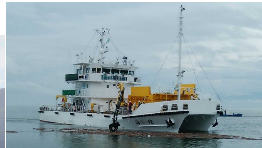
調査観測船兼清掃船 海煌(かいこう) <全長:35m、総トン数:195ト>
