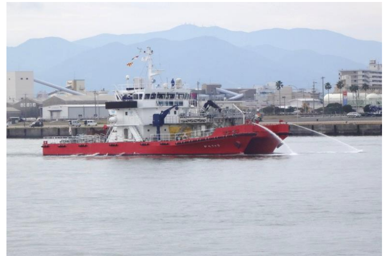
九州地方整備局所有船「がんりゅう」による放水攪拌状況
