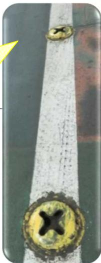
車を船で運ぶ時、揺れて車が動かないようにロープ等で固定します。その器具を留めるためのものです。
