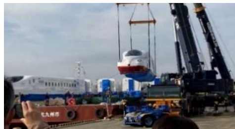
先頭車両の陸揚げ状況(重さ約30ト、全長約27.5m)
