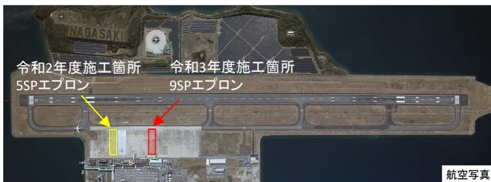
今年度は整備されて約40年が経過し、劣化が進行している9SP※2のエプロンを新しい舗装に打ち替えています。
