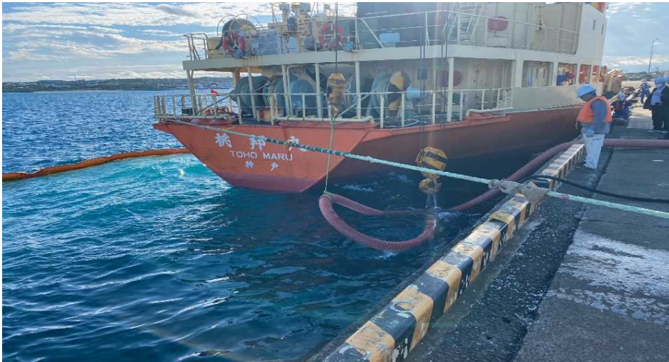
サンドポンプ軽石除去状況
