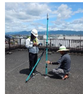
測量(VRS) (防災基準点測定状況)
