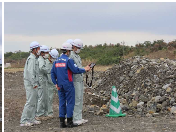
タブレットを用いた3次元計測技術
